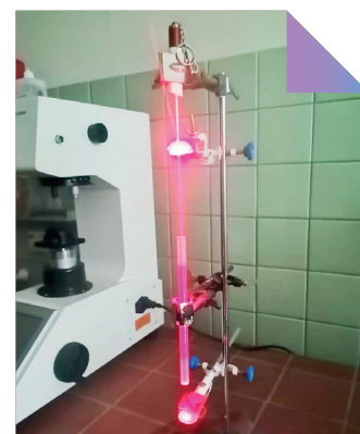
Модель твердотельного лазера на основе прозрачной керамики из иттрий-алюминиевого граната. Прохождение пучка света
